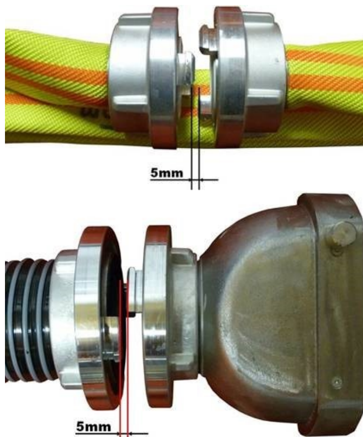
Anlage 18: Kupplungsabstand Löschangriff
